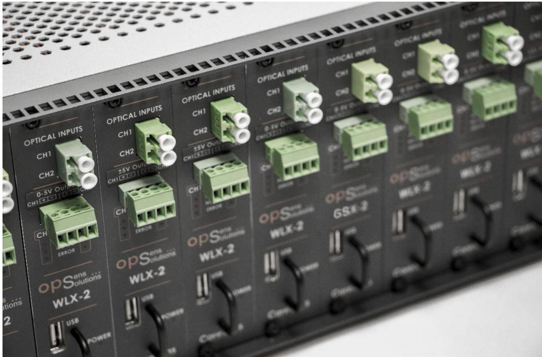
CoreSens 装置围绕双通道光纤测量模块构建，这些模块安装在机架式机箱中。WLX-2 (S) 模块与 WLPI 技术光纤传感器一起使用，用于测量温度、压力、应变或位移。GSX-2 模块与 SCBG 技术光纤温度传感器 (OTG 传感器) 一起使用。两种类型的模块可以混合在一个机箱中，每个模块都有两个光纤测量通道，每个通道的采样率高达 1000Hz，并带有两个模拟量输出通道。
